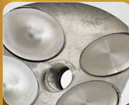
Valvole aspirazione \varnothing 25 mm - scarico \varnothing 22,2 mm
