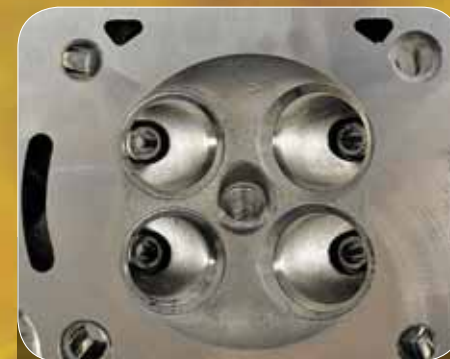
Aumento del diametro della camera di scoppio: da \varnothing 57 a \varnothing 64
